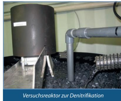
Versuchsreaktor zur Denitrifikation
