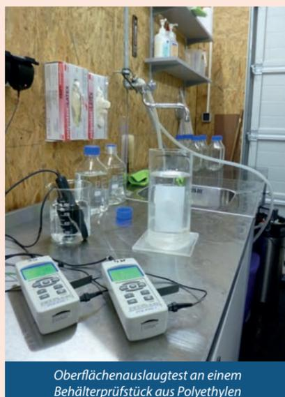
Oberflächenauslaugtest an einem Behälterprüfstück aus Polyethylen
