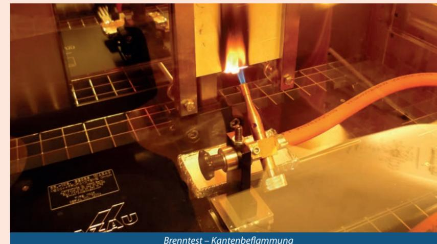
Brenntest – Kantenbeflammung
