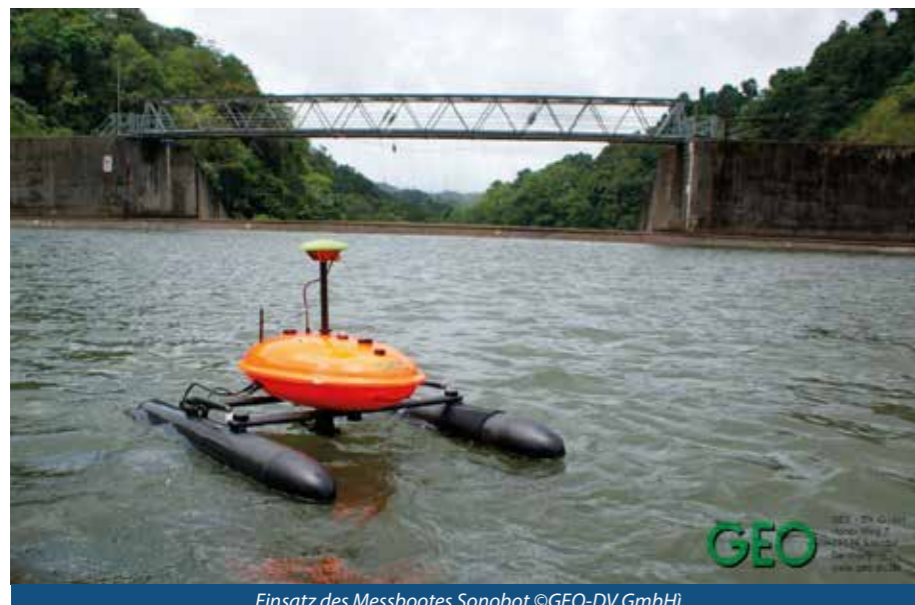
Einsatz des Messbootes Sonobot ©GEO-DV GmbH
