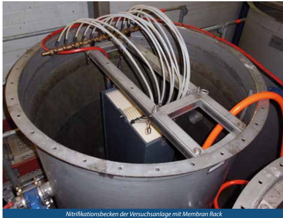
Nitrifikationsbecken der Versuchsanlage mit Membran Rack
